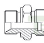
MACHÓN MÉTRICO 24° SERIE LL - L - S - BSP 60°, BSP PLANO, MÉTRICO, UNF RCTC092B6 en BSP 60° RCTC092BP en BSP plano RCTC092MJ métrico junta RCTC092UN en UNF
